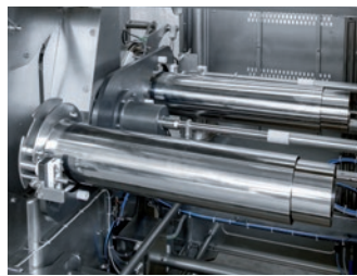
Cambio tubo automatico. Solo per versioni: BA-N, BA-S Tubes rotation automatic system. Only versions: BA-N, BA-S
